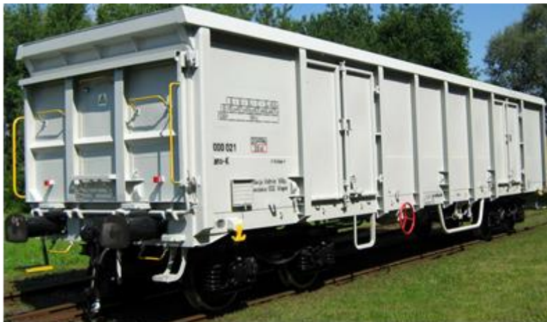
4-osiowy wagon węglarka typu 448W serii Eans-K
