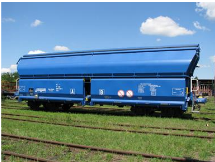
4-osiowy wagon samowyładowczy typu 441Vb serii Talns
