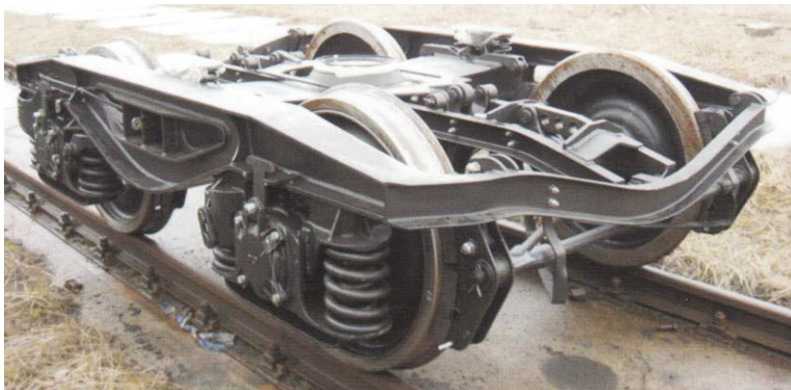
Wózek wagonowy typu 21TN serii Y25Ls(s)d1-K
