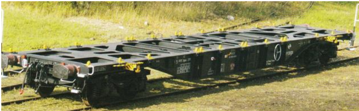
4-osiowy wagon platforma 60' typu 434Za serii Sgnss-K
