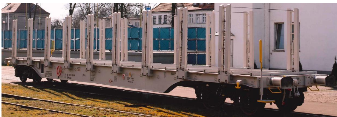
4-osiowy wagon platforma z kłonicami typu 436S serii Snps/ss
