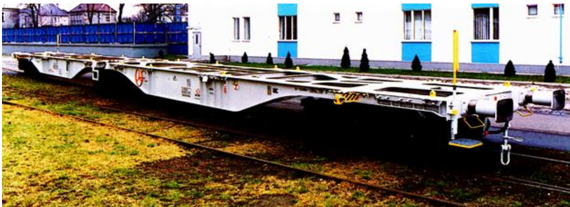
6-osiowy przegubowy wagon platforma 104' typu 626Z serii Sggmrss
