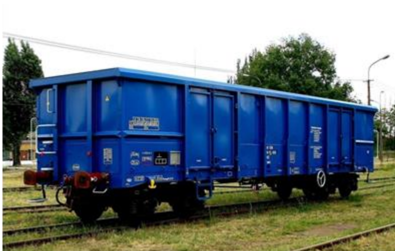
4-osiowy wagon węglarka typu 445W serii Eanos
