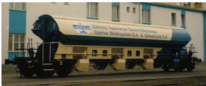
4-osiowy wagon samowyładowczy typu 439V serii Tads
