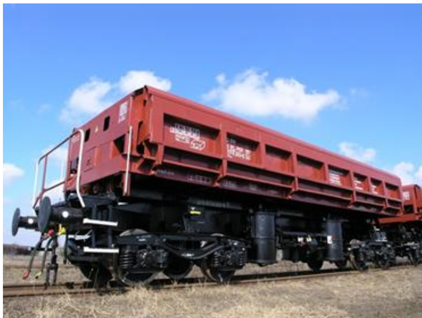
4-osiowy wagon samowyładowczy typu 418Vg serii Fas
