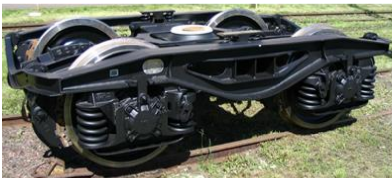
2-osiowy wózek wagonowy typu 3TNk serii Y25Ls(s)d1
