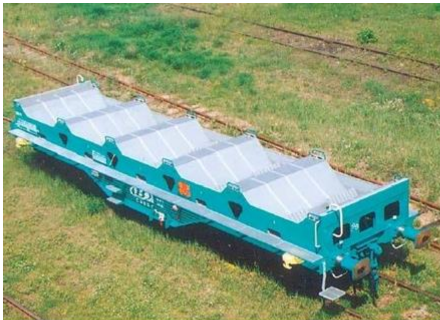
4-osiowy wagon platforma typu 437Z serii Shmmns
