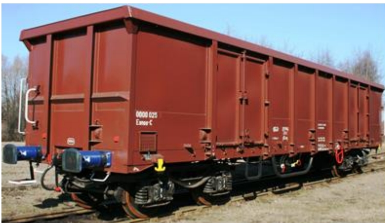
4-osiowy wagon węglarka typu 449W serii Eanos-K
