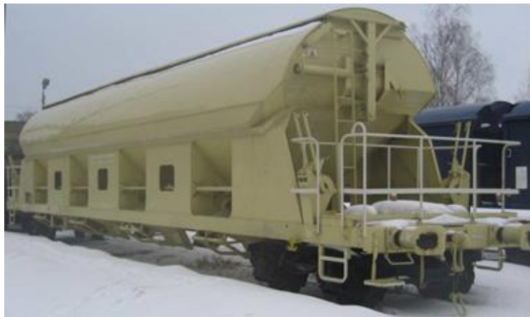
4-osiowy wagon samowyładowczy typu 444V serii Tads
