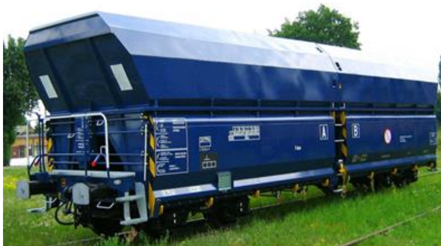
4-osiowy wagon samowyładowczy typu 454V serii Falns
