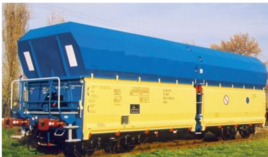
4-osiowy wagon samowyładowczy typu 440V serii Falns
