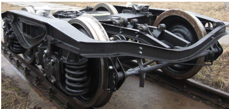
Wózek wagonowy typu 21TNa serii Y25Ls(s)1-K
