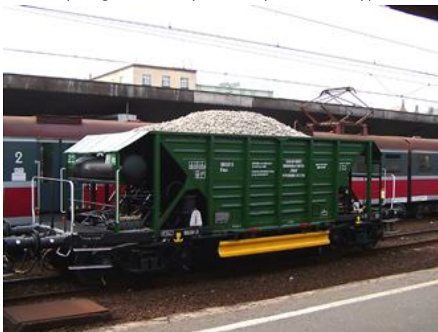
4-osiowy wagon samowyładowczy serii Fads typu 411V
